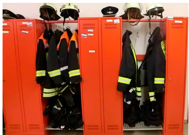
Bild 31 Spinde mit der Möglichkeit zur Schwarz-Weiß-Trennung durch Ablegen der PSA im offenen Teil und der privaten Sachen im Spindelteil daneben
