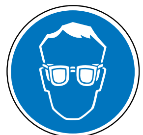
Bild 37 Hinweis auf eine erforderliche Schutzbrille
