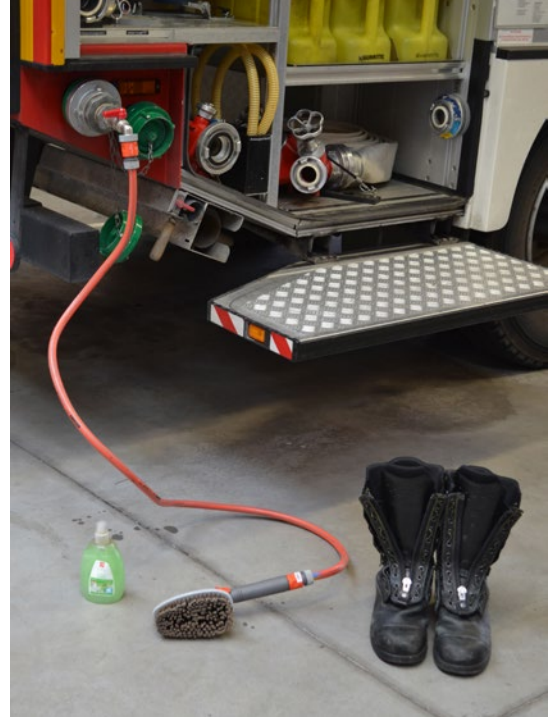
Abb. 8d Einfache Reinigungsmöglichkeit von PSA und Geräten an einem Löschfahrzeug.
